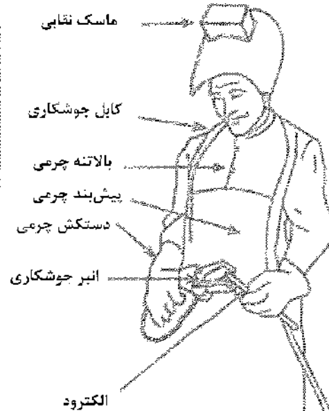
آماده شدن برای جوشکاری بالاسر
